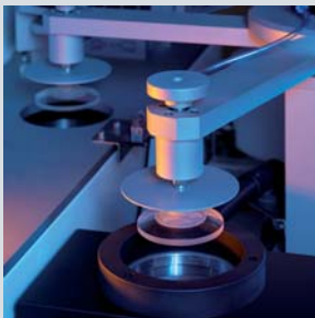
Aplicación de laca por Spin y estación de curado UV
