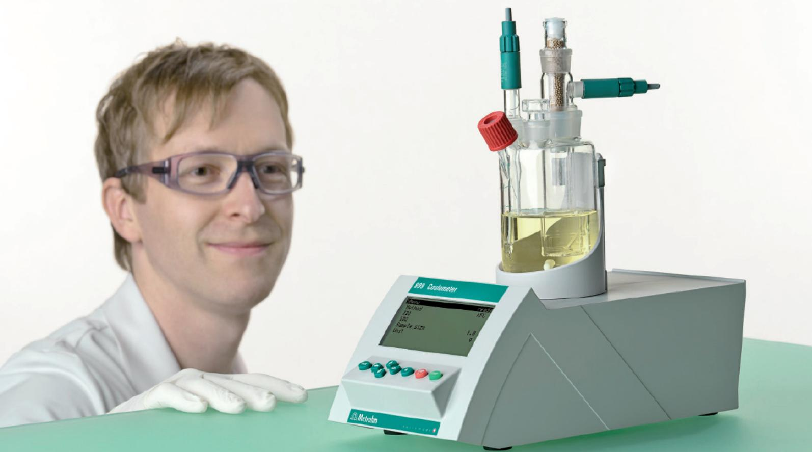
Coulómetro portátil para determinar el contenido de agua en cualquier lugar
