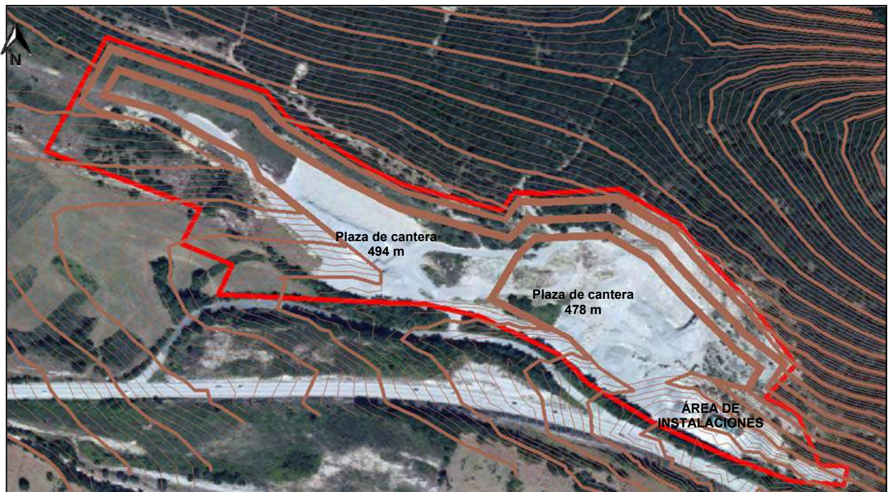
Vista del modelado final del terreno proyectado
