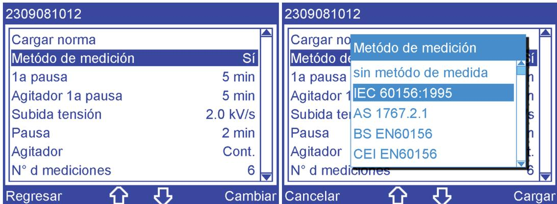
1. Seleccione "Método de medición" pulsando las teclas de flecha.
