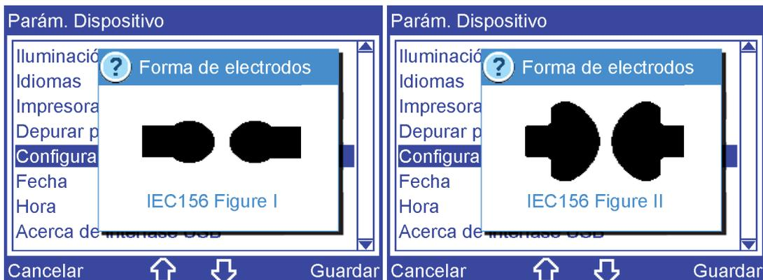
3. Seleccione una forma de electrodos pulsando las teclas de flecha.
