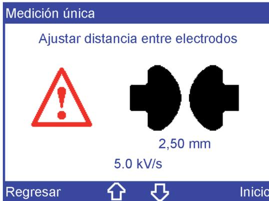
1. Ajuste la distancia entre electrodos visualizada.
