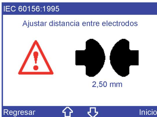
2. Ajuste la distancia entre electrodos visualizada.
