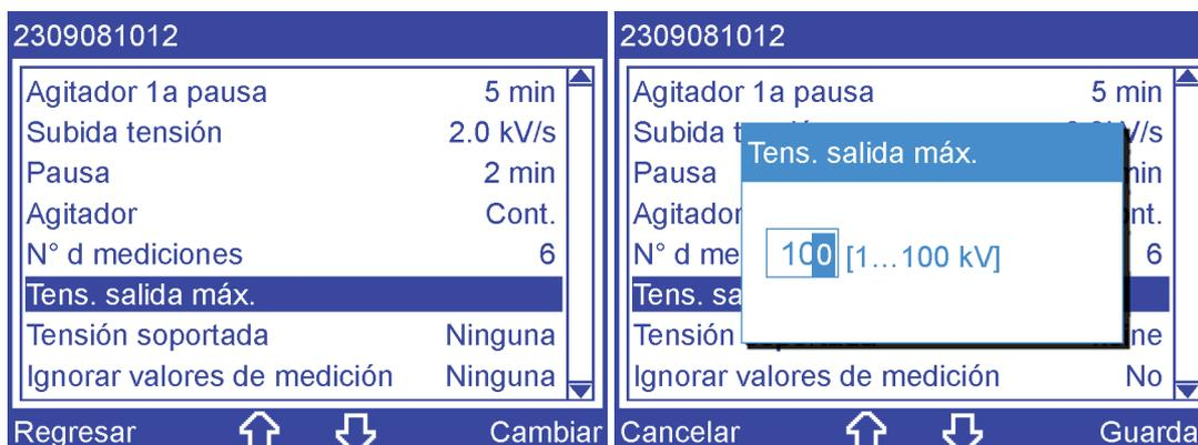
1. Seleccione "Tens. salida máx." pulsando las teclas de flecha.
